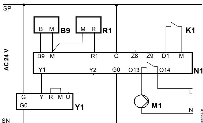
Температура на притоке с компенсацией по наружной температуре, удаленным задатчиком, переключателем уставок и управлением насосом
