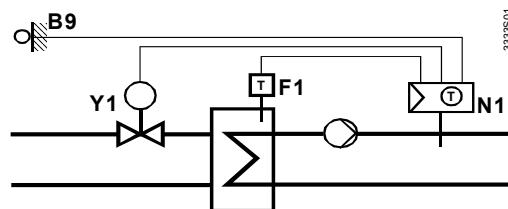
Управление теплообменником через 2-ходовой клапан в первичном контуре, компенсация по наружной температуре
