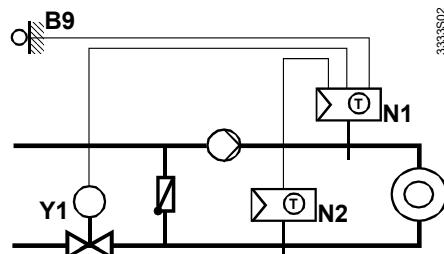
Управление температурой подающей с макс. ограничением темп. вторичного контура в ГВС, компенсация по наружной темп.
