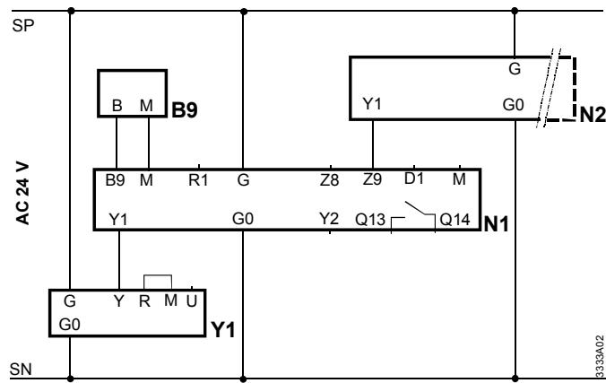
Управление температурой подающей воды, компенсацией по наружной температуре и ограничением по максимуму температуры подающей
