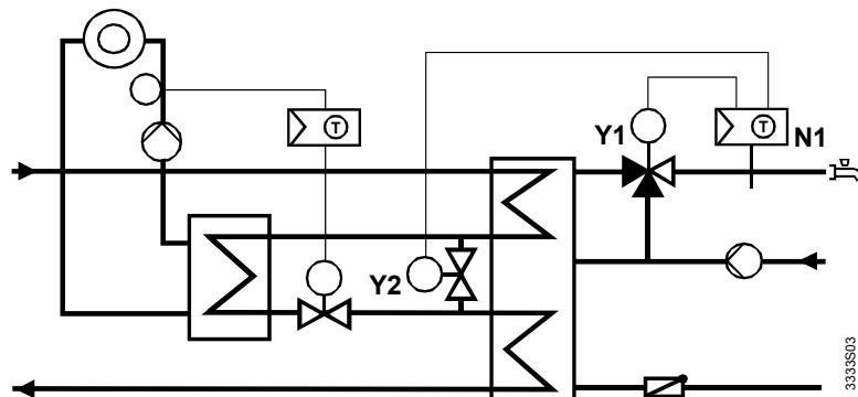
Прямой нагрев ГВС через теплообменник, Y1 управляет смешивающим клапаном контура ГВС, Y2 управляет 2-ходовым клапаном первичного контура ГВС
